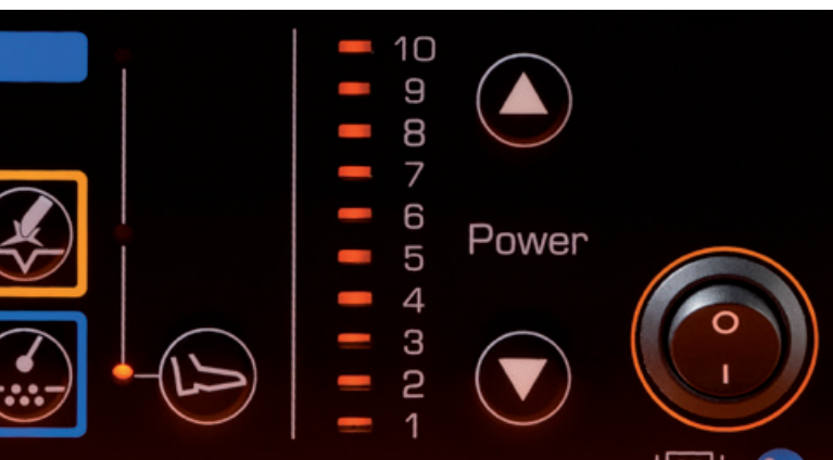
Up and Down: настройка до 100 ватт в 10 шагов
