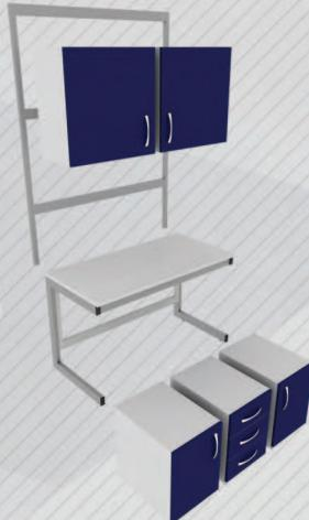
Базовым элементом модульной системы является лабораторный стол с основанием в виде массивной С-образной стойки из металлического профиля 30 x 60 мм, которая позволяет выдерживать нагрузку до 300 кг
